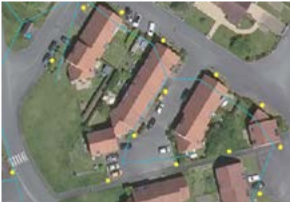
Réseau d'éclairage public non géoréférencé.
